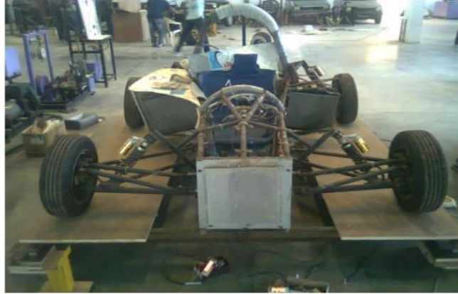
ภาพประกอบที่ 2 การวัดตำแหน่งจุดศูนย์กลางของแรงโน้มถ่วง (center of gravity: COG) ของรถ SUPRA SAE CAR [1]
