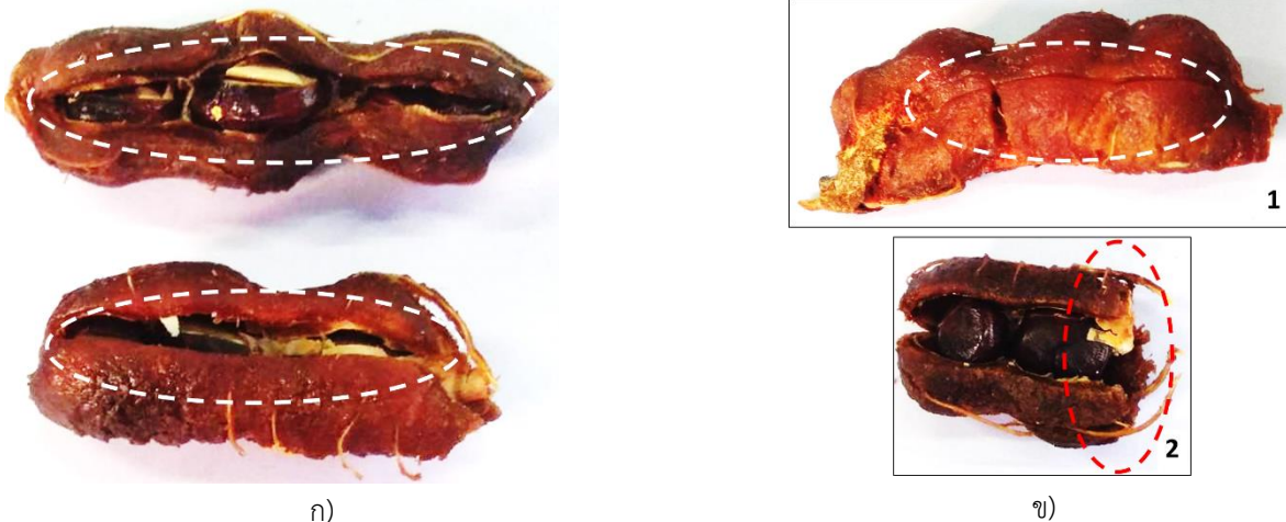
ภาพประกอบที่ 7 ลักษณะฝักมะขามที่ถูกกรีดเนื้อโดยเครื่องกรีดเนื้อมะขามหวานสุกหวาน
