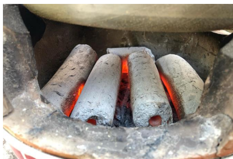
ภาพประกอบที่ 4 การติดไฟของถ่านอัดแท่งเปลือกผลมะค่าโมง
