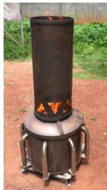
ภาพประกอบที่ 1 การเผาเปลือกมะค่าโมงโดยใช้เตาเผาแบบไร้ควัน อุณหภูมิ 900 องศาเซลเซียส ที่มา: ทศพร สีหิน และคณะ, 2563
